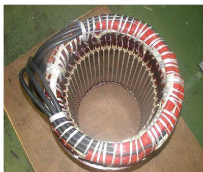
Fig. 1.4 : Bobinage réparti pour machine à flux radial [Leroy Somer]
