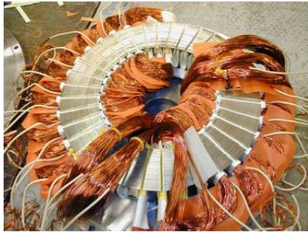
Fig. 1.7 : Bobinage réparti pour machine à flux axial [PAR 05]
