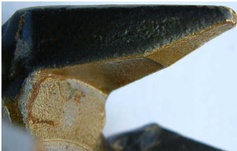
figure I-13 : Vue d'une griffe de l'alternateur A
