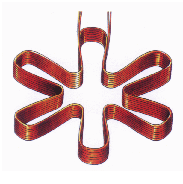
figure I-6 : Marguerite, mise en forme du bobinage ondulé d'une phase
